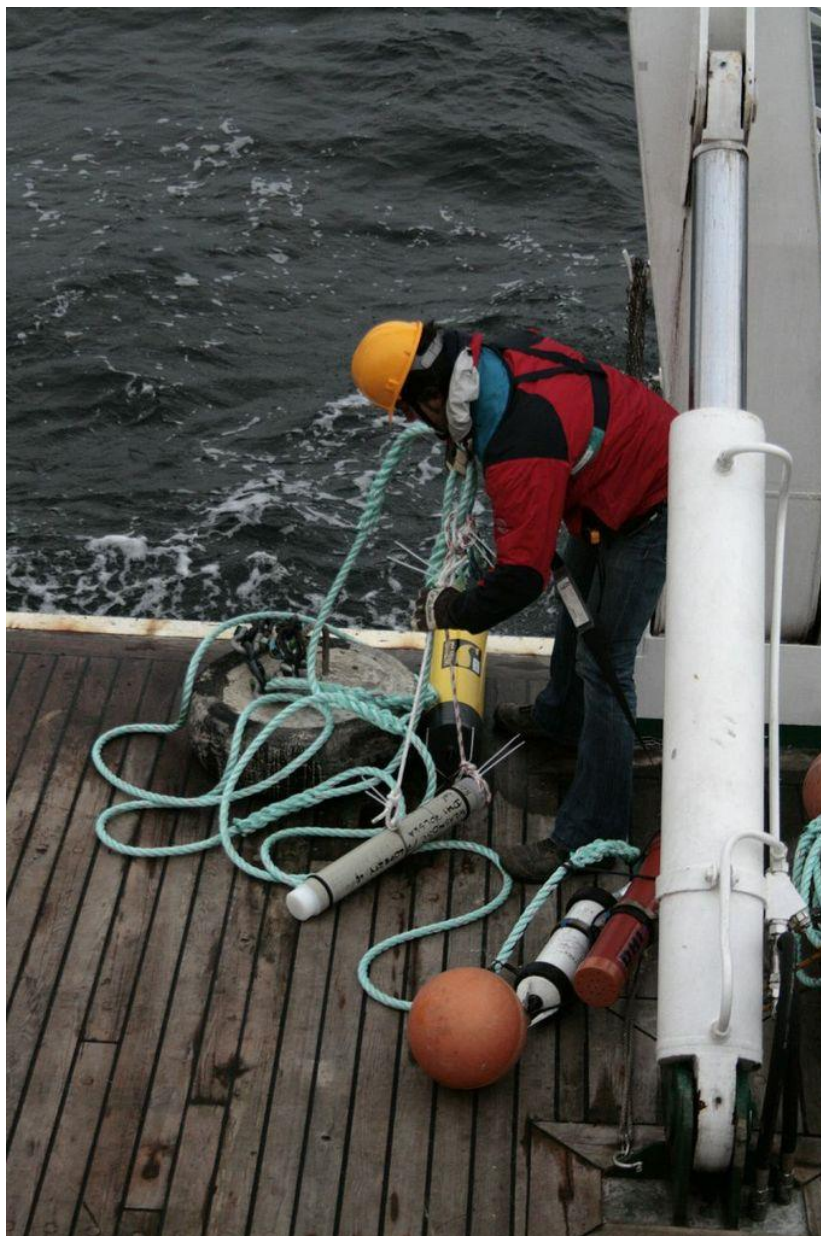
Rys. 19 Urządzenia akustyczne gotowe do umieszczenia w wodzie
